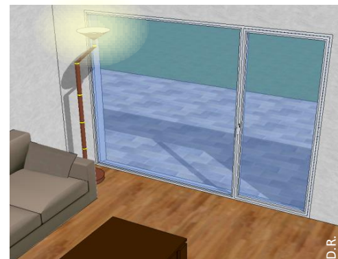
Un éclairage de type halogène à proximité du vitrage ou orienté vers le vitrage.
